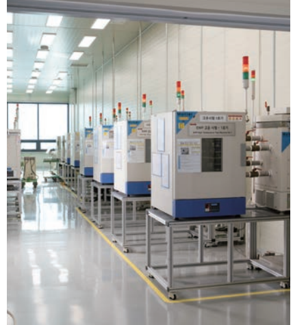
Electric Water Pump 고온 내구 시험기
