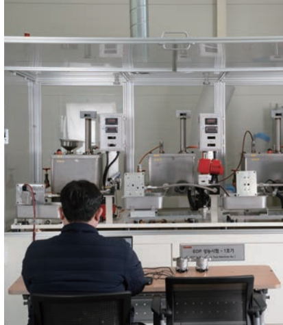
Electric Oil Pump 성능 시험기
