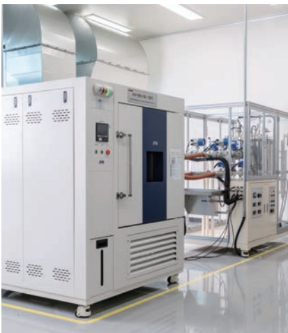
Electric Water Pump 성능 시험기
